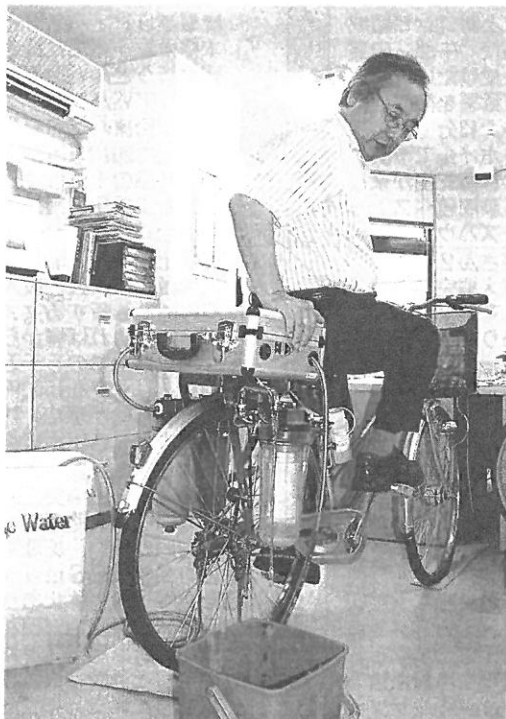
自転車一体型浄水装置「シクロクリーン」にまたがる勝浦さん。くみ上げられた水は後輪脇の三つのフィルターで綺麗になる＝川崎市中原区で
